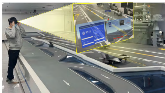
图 21 舰载机着舰引导感知与决策原型系统 [124]
