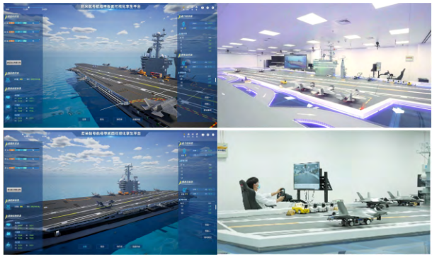
图 18 航母航空保障作业数字孪生实验平台
