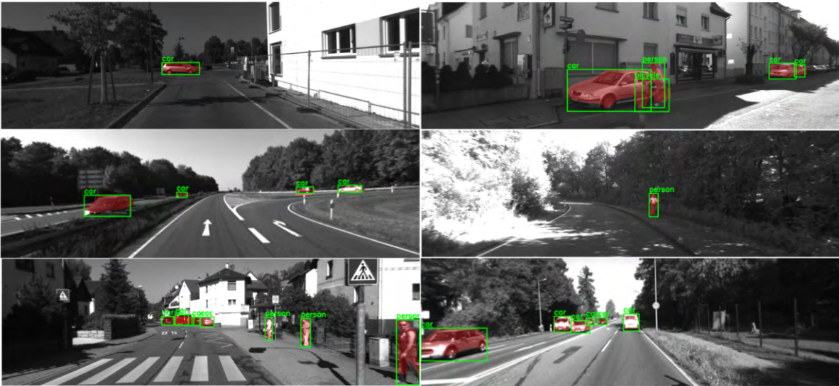
图 10 DHSR-YOLOSeg模型在不同KITTI序列上的动态目标语义分割结果
