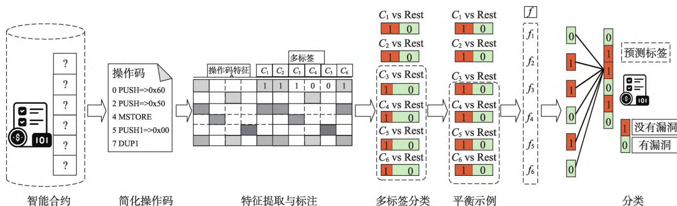
图8 ContractWard方法检测流程
